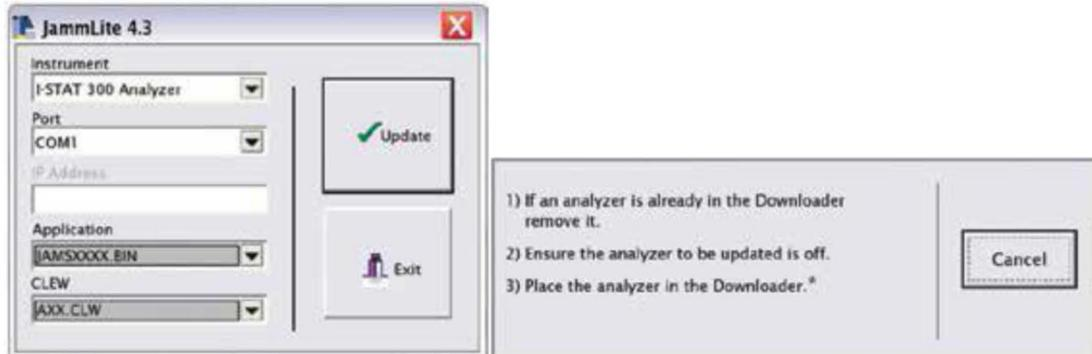
10. Confirmar que el analizador está APAGADO y colocarlo en la base azul.
